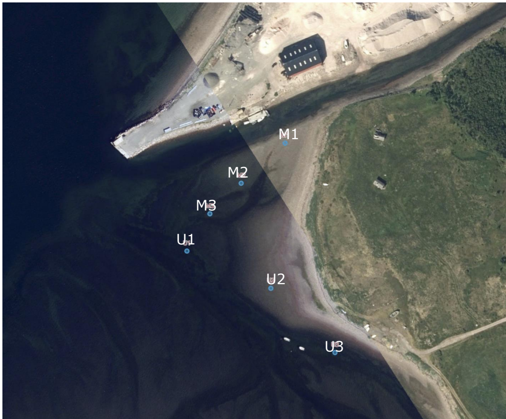
Figur 2: Stasjoner M1-M3 og U1-U3 for uttak av sedimentprøver ved Austertana (U1 ble ikke prøvetatt). Fem delprøver er tatt innenfor området som hver stasjon representerer.
