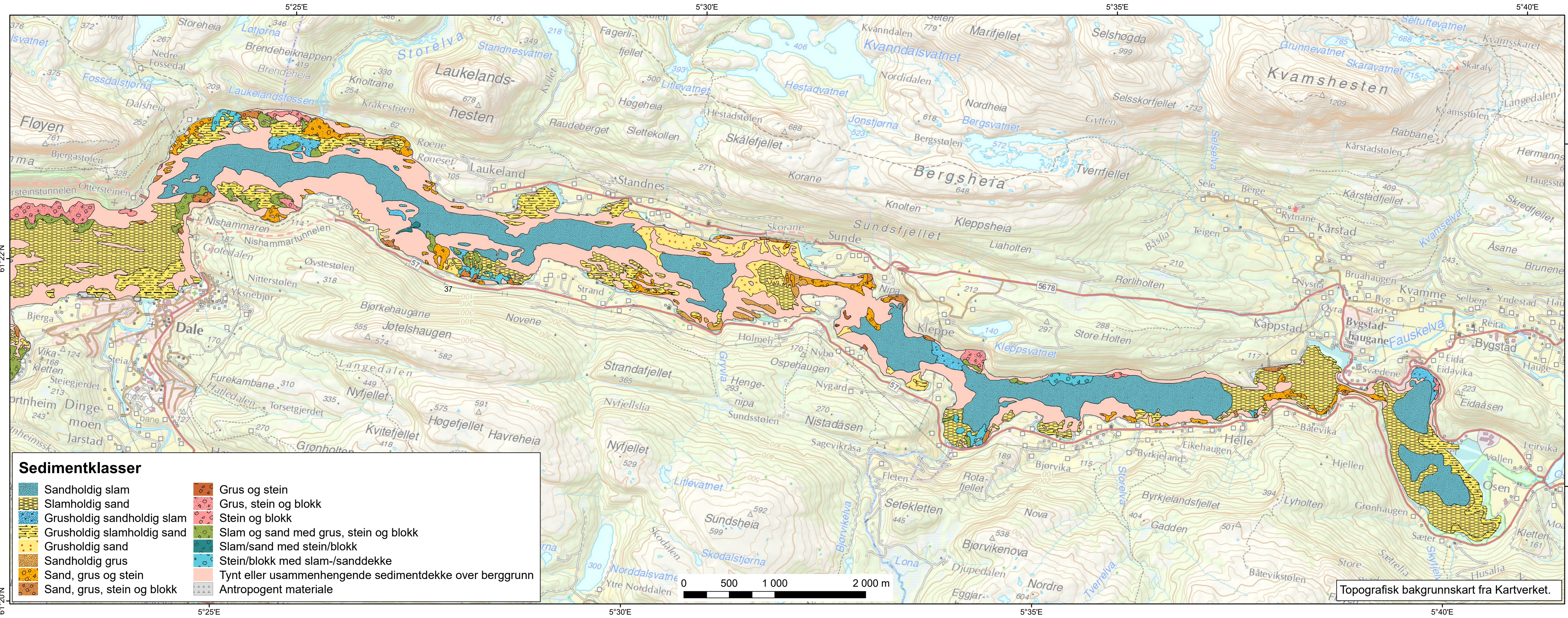
Sedimenter på havbunnen i Dalsfjorden er kartlagt basert på detaljerte batymetri- og reflektivitetsdata, sedimentprøver og videolinjer. Bunnsedimentene er inndelt i 20 klasser. Kartleggingen følger metodikken beskrevet i Elvenes m. fl. (2019). Bunnsedimentkartet (kornstørrelse) danner grunnlag for flere temakart, for eksempel ankringsforhold og gravbarhet. Kartene er produsert digitalt og er tilgjengelige på [www.ngu.no](http://www.ngu.no)
