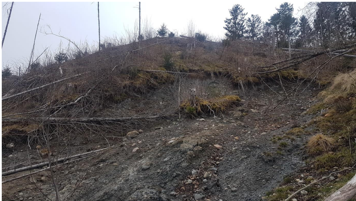
Figur 6 Utglijning av terrenget nedenfor biloppsamling. Det er elveavssetninger i blanding med finkornet materiale, trolig havavssetninger. Foto: O. Soldal 4. mai 2021.
