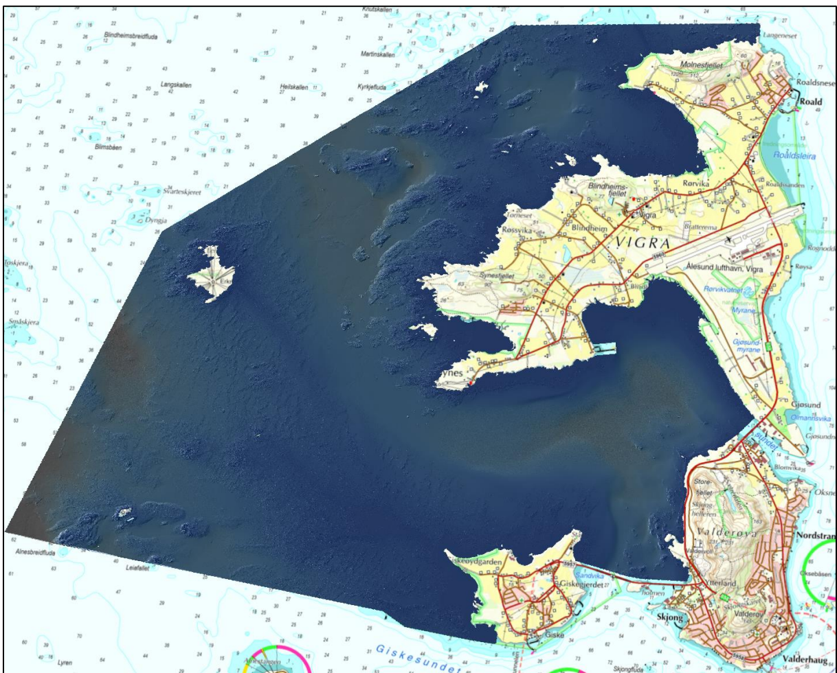
Figur 7. Kombinert farge- og skyggemodell av djupneforholda innanfor området det vart meldt oppstart for (kjelde: Statens kartverk).
