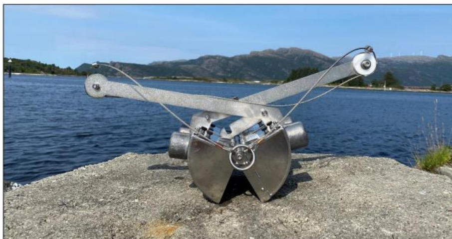
Figur 2-1: Van Veen grabb, egnet for prøvetaking av sediment
