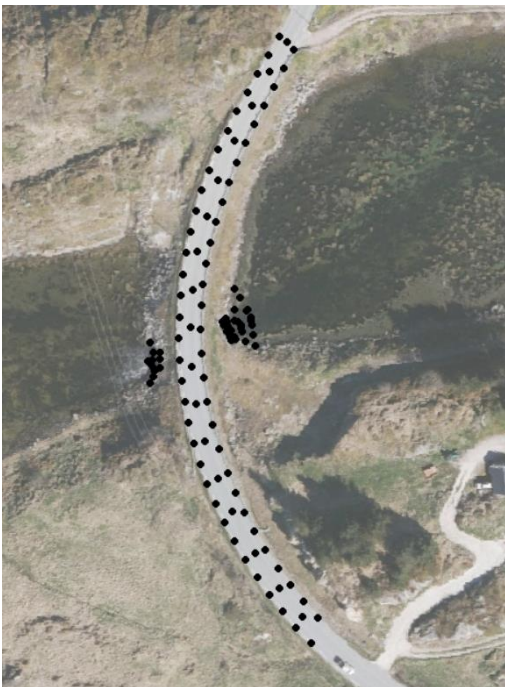
Figur 6-1. Innmålinger gjort ved Massvåg bru.
