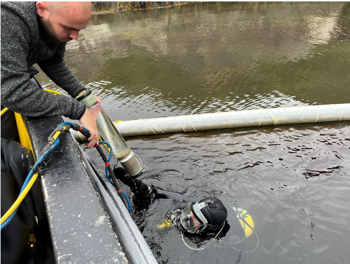
Figur 2-1: Bilde av prøvetakingen ved Engebø utført av yrkesdykkere og håndholdt kjerneprøvetaker. Foto: Kine Øren/Sweco.
