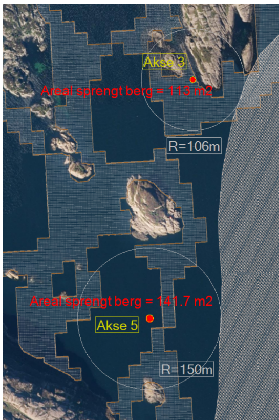
Figur 2. Oversiktskart over akse 3 og 5. De to røde prikkene indikerer senter av de to aksene, der den sørlige prikken er akse 5 og den nordlige er akse 3. Areal sprengt berg for akse 5 er 141,7 m 2 og for akse 3 113 m 2 . Registrert gyteområde for torsk og hyse er skravert med grått øst for tiltaket. De hvite sirklene rundt de to aksene indikerer avstand til det registrerte gyteområdet og er 150 meter for akse 5 og 106 meter for akse 3. Den lyse skraveringen innenfor de brune strekene er tidligere registrert taeskog.
