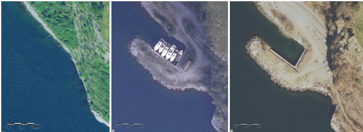
Figur 2. Området har siden 2004 (venstre) blitt utfyllt. Moloen og kaien ble brukt mens området var militært (2008 i midten). I de siste årene har ikke moloen og kaien blitt brukt (2017 til høyre).
