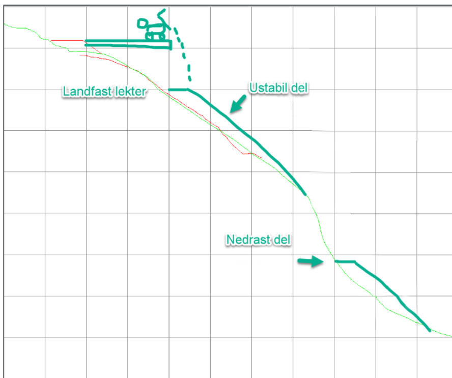
Figur 2-5: Skjematisk snitt av hvordan prosessen ved dypvannsdeponiet vil se ut. Trailere vil kjøre ut på strandkantdeponiet, for å så tippe ut sprengsteinsmasser. Disse vil legge seg langs bergveggen (ustabil del), og en del vil falle helt ned mot bunnen av bergveggen (nedrast del).
