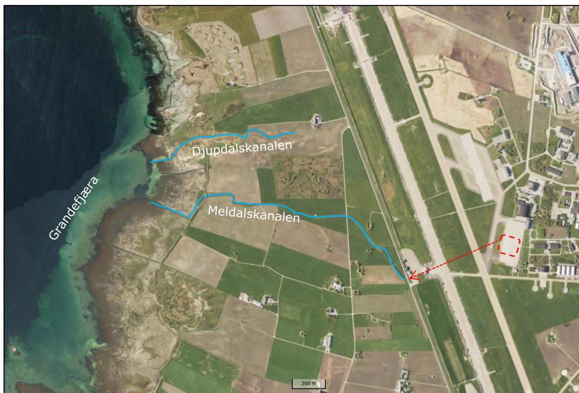
Figur 3. Avrenning fra AWACS-plattformen på Ørland flystasjon og videre til Meldalskanalen og Grandefjæra via overvannssystemet.
