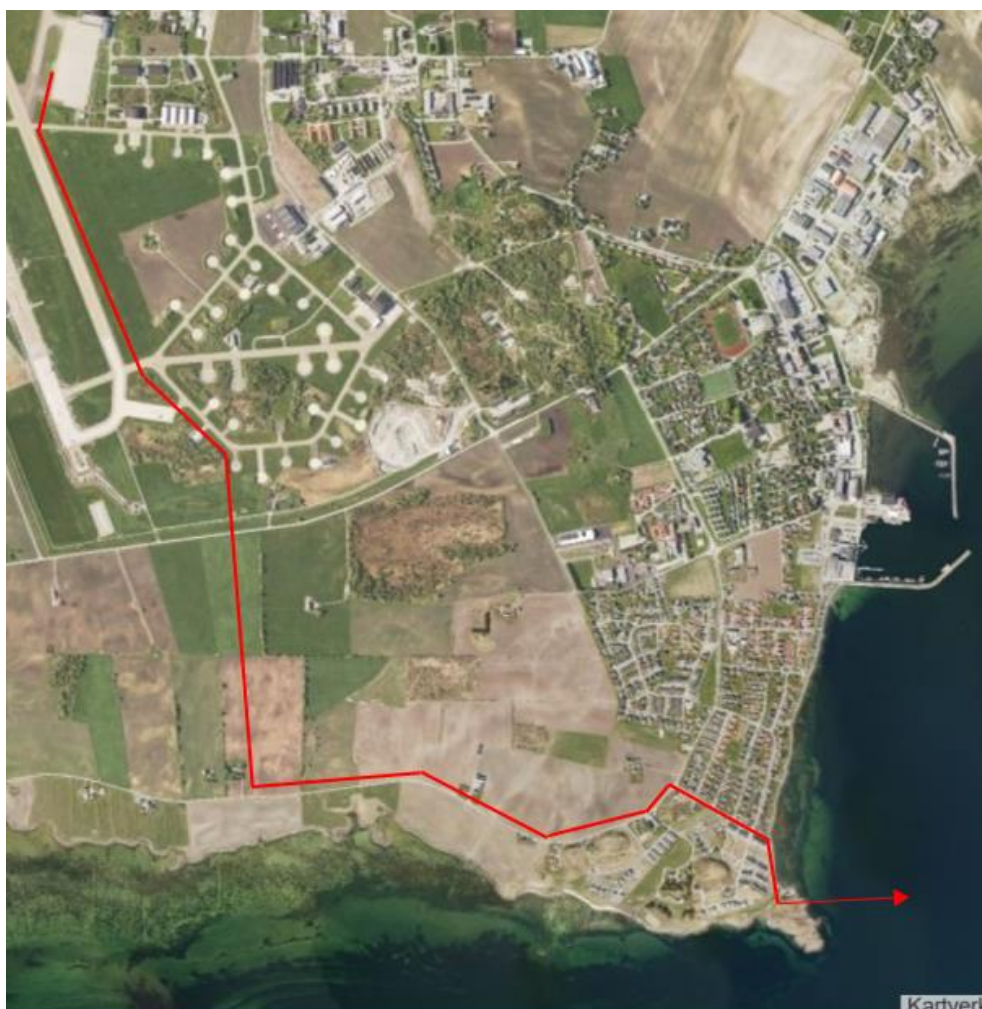
Figur 11. Alternative utslippspunkt for glykolholdig overvann til sjø fra AWACs-plattformen på Ørland flystasjon.
