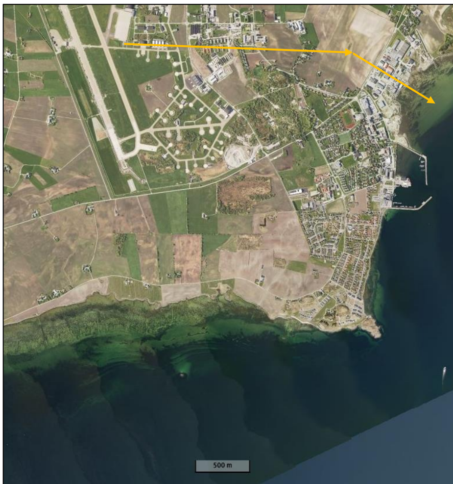
Figur 13. Overføring av glykolholdig overvann med utslippspunkt til Brekstadbukta.
