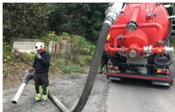
Supersuger samler effektivt opp granulat som har havnet utenfor fast underlag. Foto: NFF.
