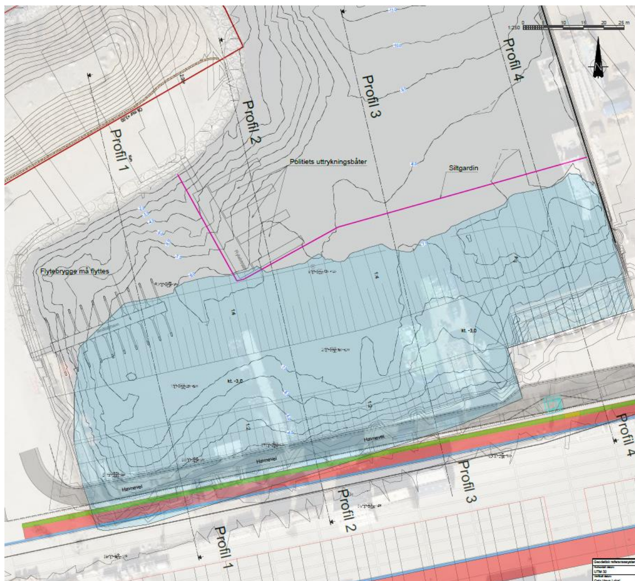
Figur 3 Nytt forslag til utfylling i bukta er vist med lyseblå farge og inkluderer området for motfylling. Profil 3 og 4 er gitt i Figur 4. Foreslått plassering av siltgardin er gitt med rosa strek rundt brygge for utrykningsbåter nord i bukta.
