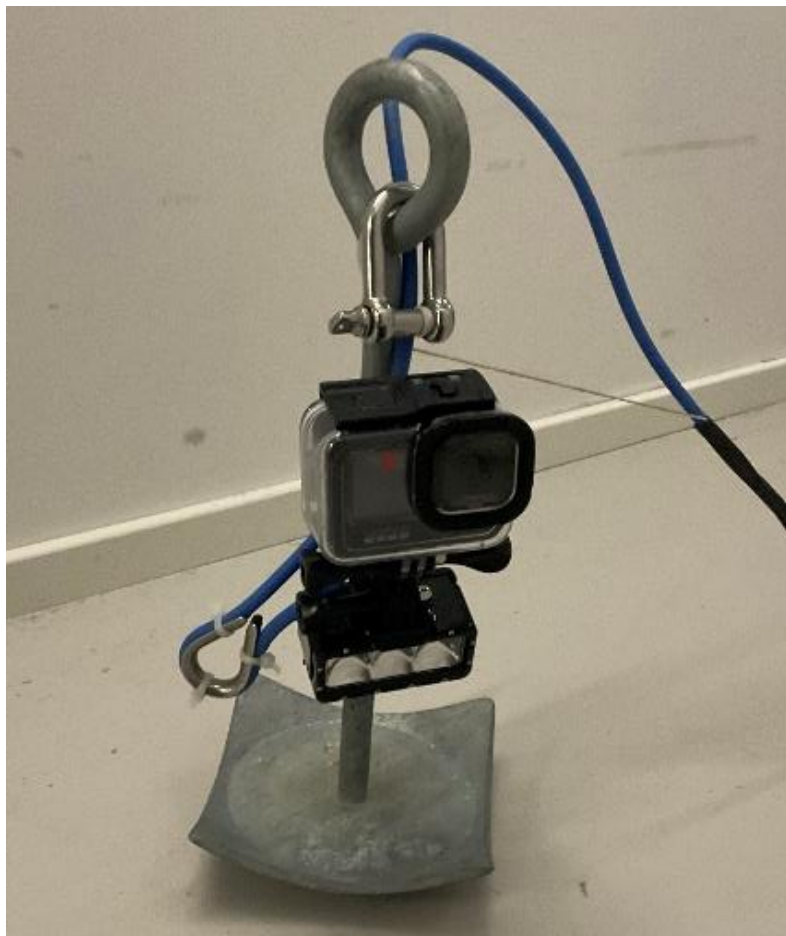
Figur 13: Droppkamera: GoPro Hero 9 og undervannsslykt påmontert et 3 kg skållanker, med transmitter for live strømming, bildetaking og videooptak via iPad. Droppkameraet er utarbeidet av Ole Skuggevik hos Norconsult Norge AS. Fotokilde: Norconsult Norge AS.
