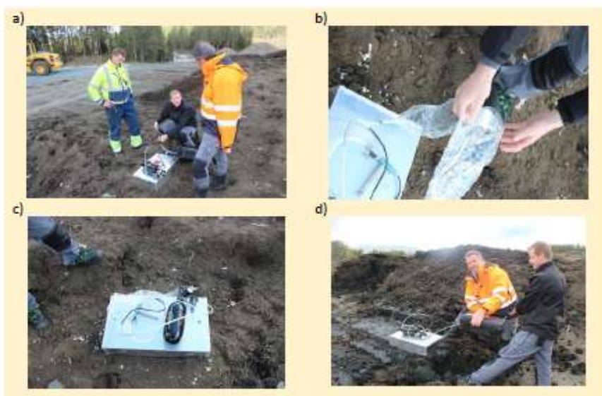
Figur 6. a) Prøvetaking fra overflaten av mellomlagret utråtnet slam, b) Prøveemballasje, c) Prøvetakingsverktøy med luktkammer, filtrert trykkluft for å sikre marginalt overtrykk og prøveuttak med emballasje og d) Prøvetaking fra mekanisk bearbeidet slam
