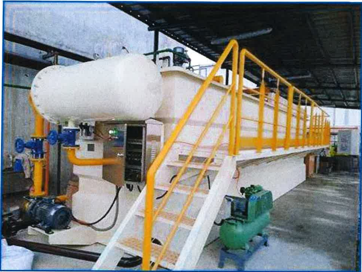
Figur 2-1: Typisk design av DAF-anlegg (50 m 3 /h).
