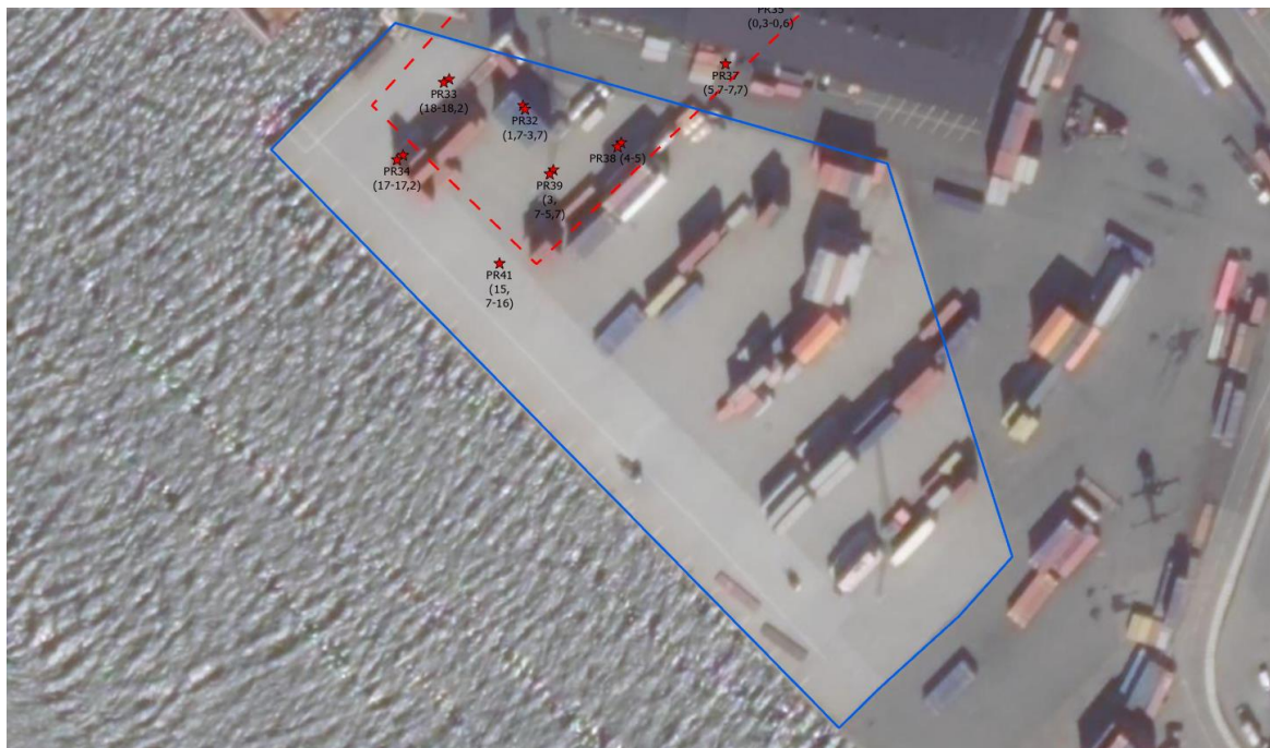
Figur 8. Flyfoto fra området på Dokken som ble etablert ved sjøutfylling ferdigstilt i 2015. Prøvepunkter fra miljøteknisk grunnundersøkelse utført av Multiconsult i 2023 er markert med røde stjerner, der deler av utfyllingsområdet omfattes av tomt A2 (rød stiplet linje).
