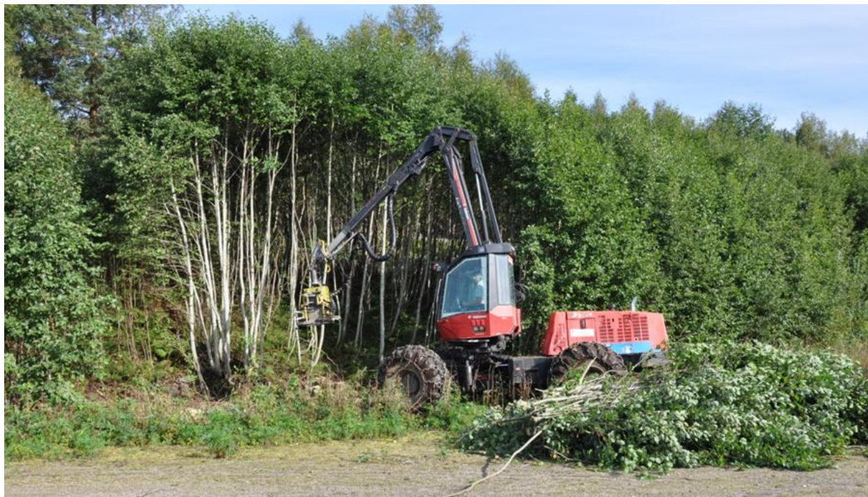
Figur 13. Valmet 911.1 med Bracke C16.a fellehode. Molde 2011. Foto: Leif Kjølsten.
