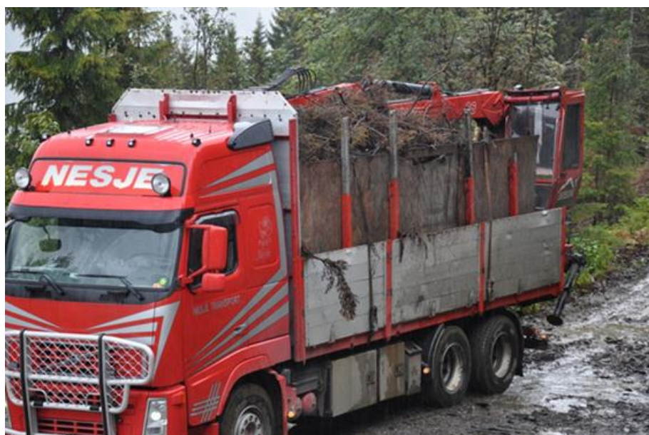
Figur 18. Tømmerbil med tette aluminiumskarmar og innlagt plater.
