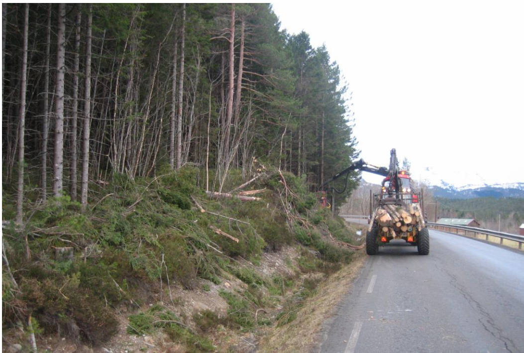
Bruk av hogstmaskin og traktor med tømmerhengar til rydding av skog langs viltusett strekning i Halså kommune vinteren 2008.
