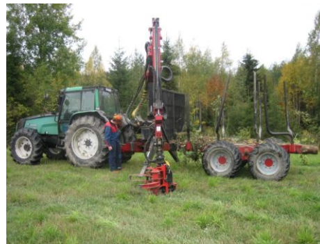
Figur 16. Klippeaggregat påmontert traktor med kran og hengar
