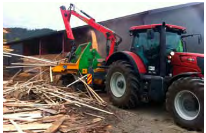
Flising av rivningsvirke. Kilde: Bioland AS.
