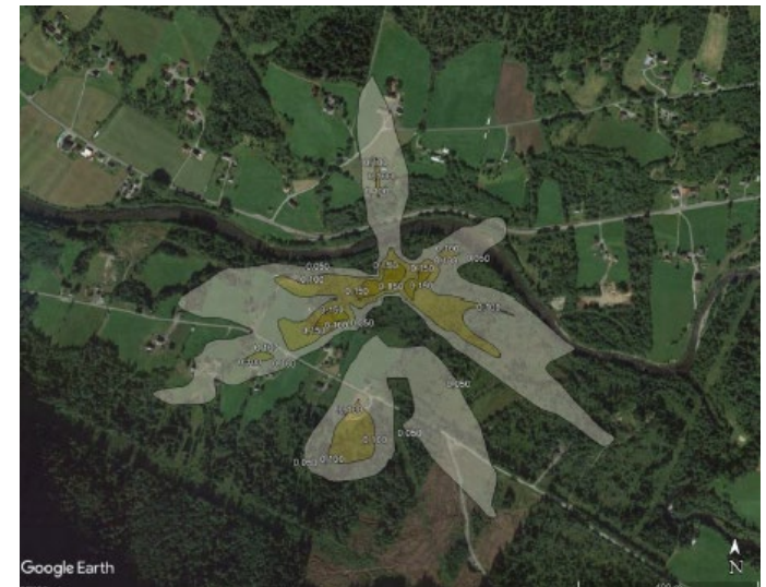
Luktkonsentrasjonar gitt som maksimal månadleg 99 prosent timefraktal i november for reinsa utslepp. Grenseverdiane er gitt i OUE/m 3 . Resultatet viser at luktemisjonar vil vere under grenseverdien frå Fylkesmannen (0,150 mørke gult-maks, 0,100 lyse gult, 0,050 kvit).
