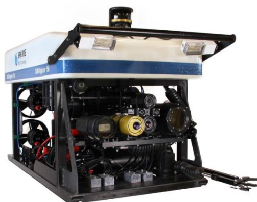
Figur 2-1. Bilder som viser fartøystype (Dykkerservice 6) og ROV (SPERRE Subfighter 15K) brukt under den visuelle undersøkelsen i Førdefjorden våren 2014.
