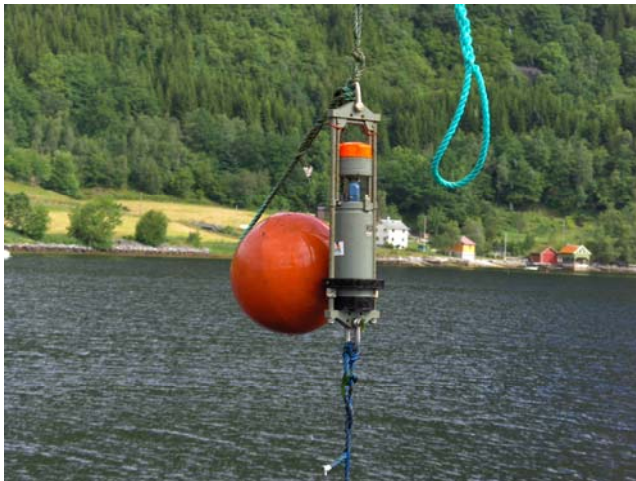
Figur 2. Bildet til venstre viser en av strømmålerne (RCM s/n 635) under opptak.. Bildet til høyre viser Grytaelvas utløp, sett mot strømmåleren. Grytaskjeret sees rett bak den hvite båten i bildet.(Foto: Mats Thoresen).
