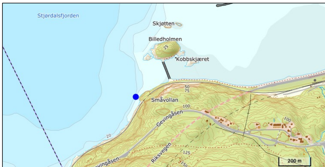
Figur 7. Illustrasjon av utslippspunkt (blå sirkel) med relativ størrelse på innblandingssonen for TSS. Det blå punktet er ca. 20 m i diameter [44].
