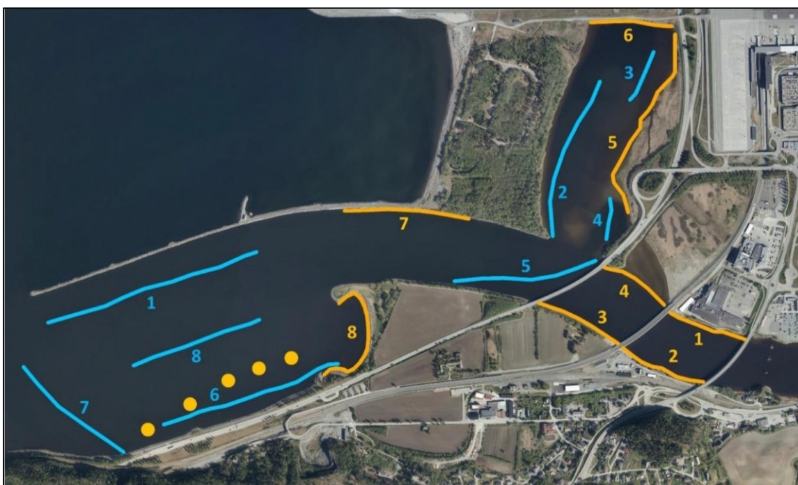
Figur 5. Undersøkelsesområdet for fiskeundersøkelser og kartlegging av bunnforhold med ROV. Blå linjer, ROV-transekter; oransje linjer, overfiske med elektrisk fiskebåt; oransje sirkler, plassering av ruser.
