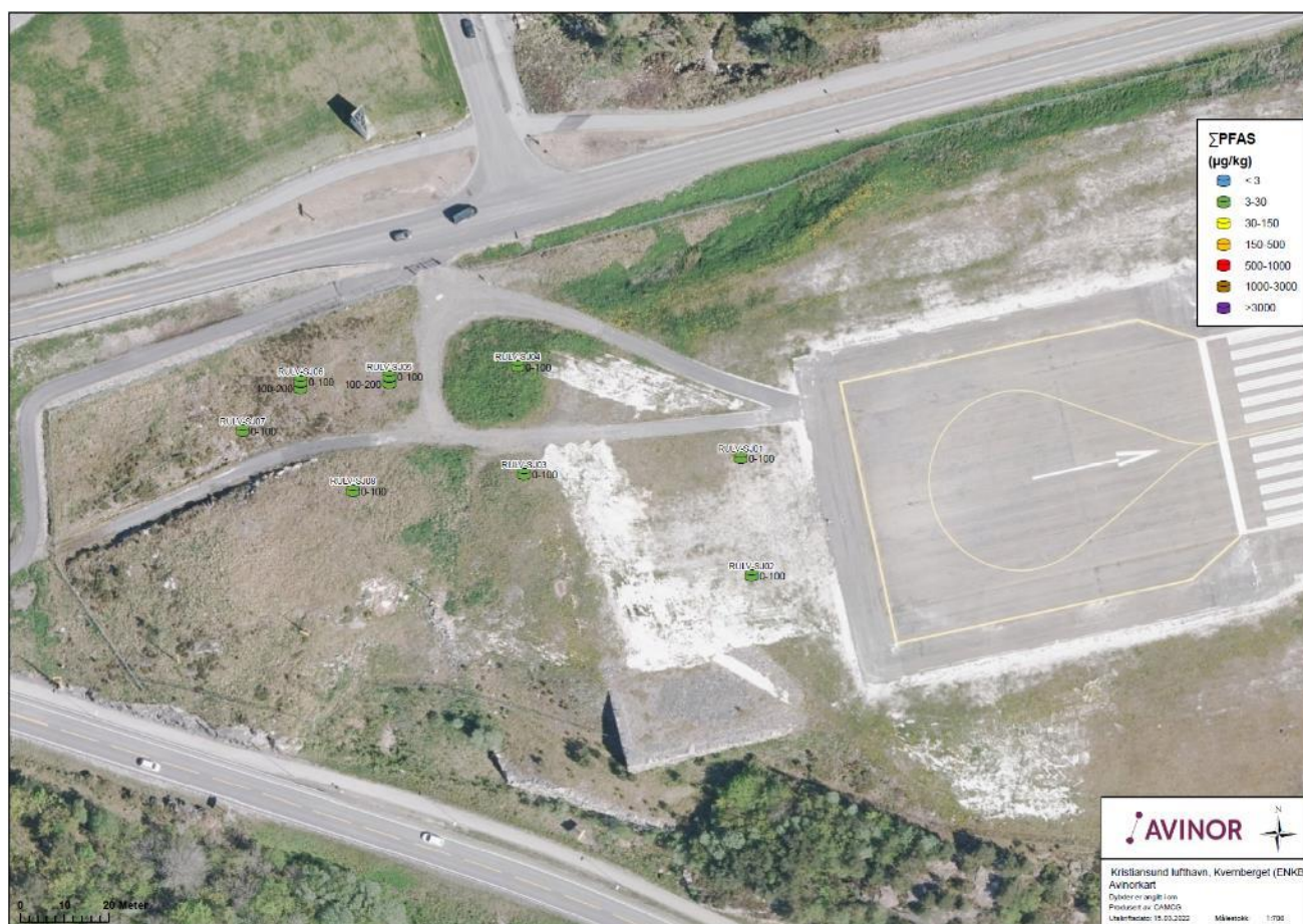
Figur 47 Kart over prøvepunkter ved RULV (vest for rullebanen) på Kristiansund lufthavn. Prøvepunkter er klassifiser iht. konsentrasjonsintervaller for \Sigma PFAS ( \mu\text{g}/\text{kg} ). Kartet viser nye prøvepunkter fra 2021 (dette området er ikke prøvetatt tidligere).
