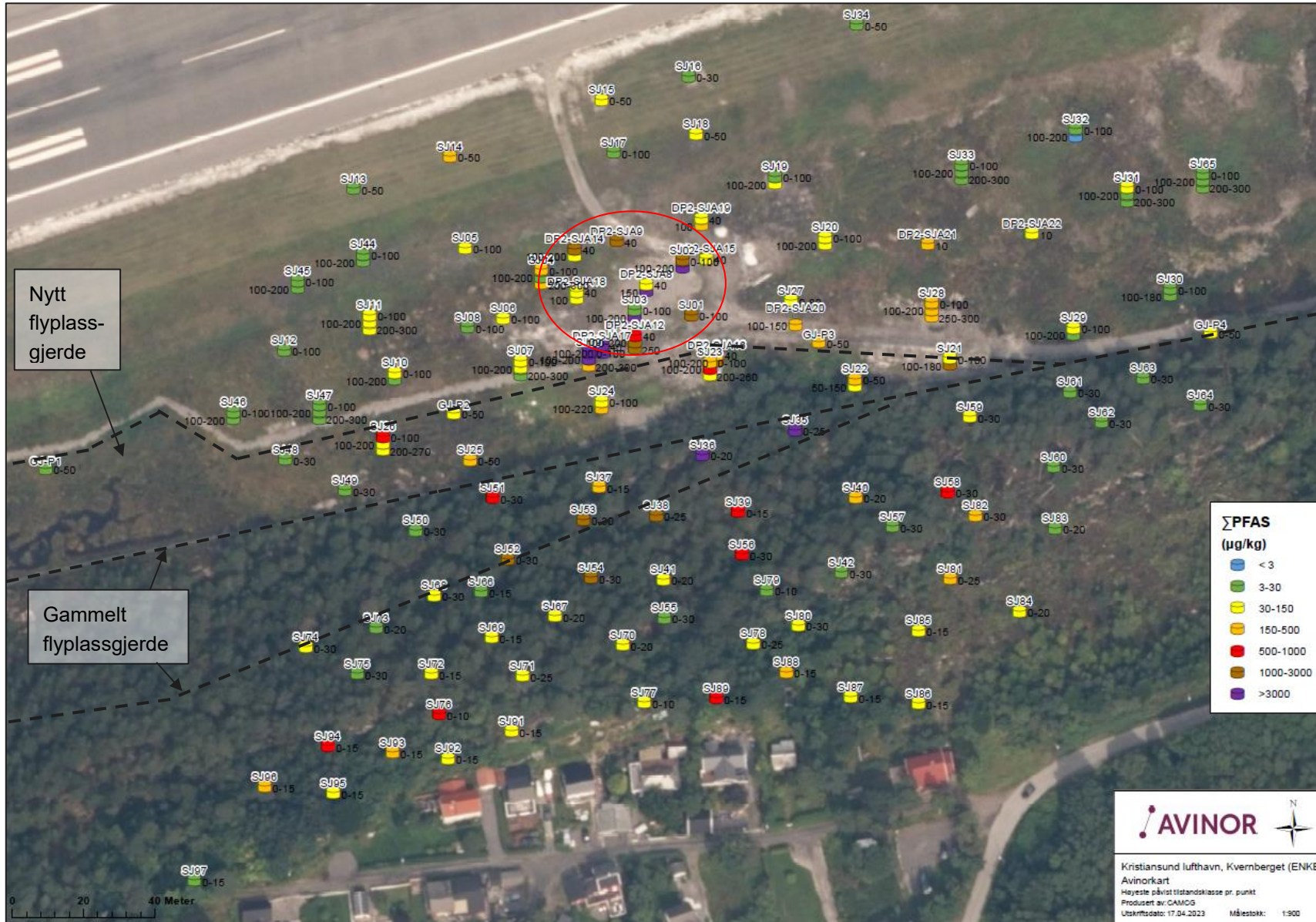
Figur 38 Kart over prøvepunkter fra 2011-2022 ved BØFB ved Kristiansund lufthavn. Prøvepunkter er klassifisert iht. konsentrasjonsintervaller for \Sigma PFAS ( \mu\text{g}/\text{kg} ) jf. Tabell 1. Omtrentlig plassering av tidligere øvingsområde er vist med rød sirkel. Omtrentlig plassering av gjerdetrasé er vist med sorte, stiplede linjer.
