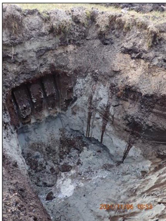
Figur 30 Bilde fra prøvetakning av løsmasser i punkt TERM-SJ02 i november 2021. Vann renner ned i overgangen til finere masser.
