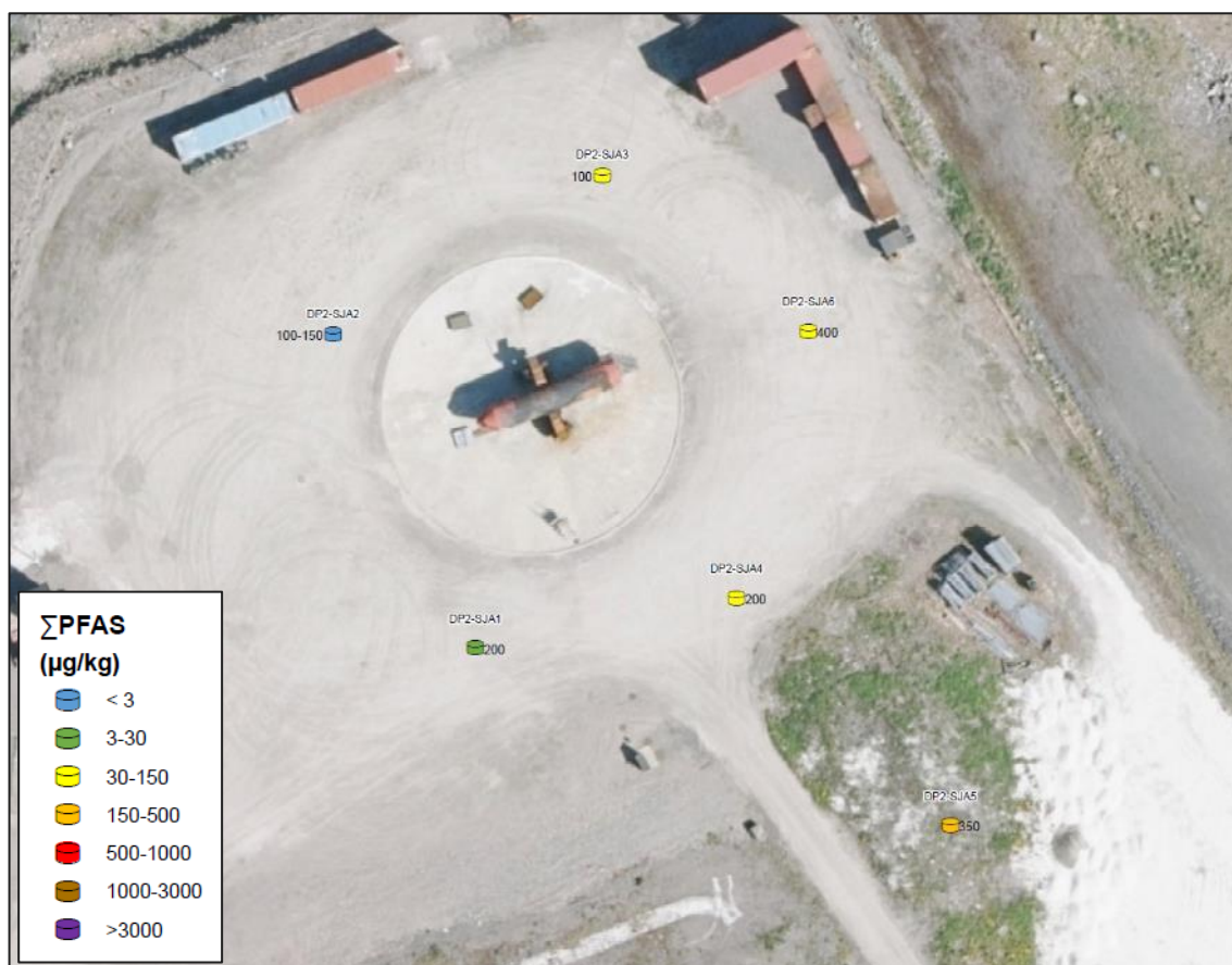
Figur 18 Jordprøver ved BØFA kartlagt i 2011-2012 («DP2»), fargeklassifisert med fargekoder for sum PFAS per dybdenivå (kart utarbeidet av Avinor).
