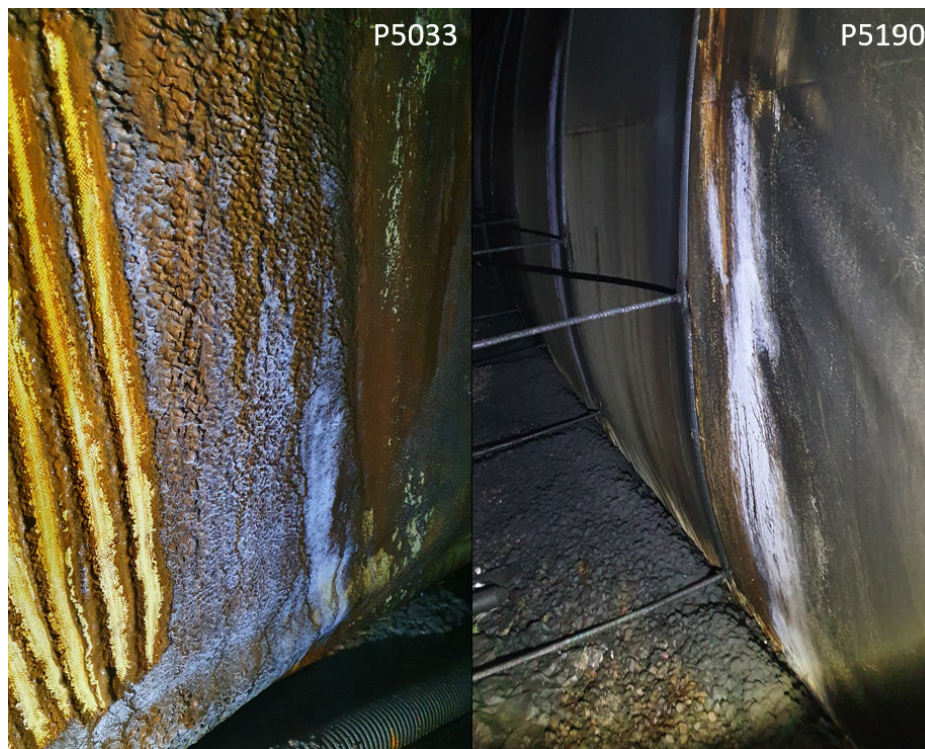
Figur 5 Pelnummer 5033 og 5190. Observasjoner av hvitt slam på Gjertsen-duken. Vertikale striper på bildet til venstre stammer fra prøvetakingen.
