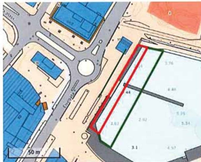
Figur 2. Oversiktskart som viser området berørt av peling (rødt) og hvor sedimenter skal mudres (grønt). Kartkilde: Norgeskart.no
