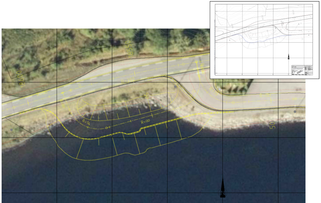
Figur 6. Skisse av fylling, holdeplass for buss på Horn. Fyllingen vil komme noe lenger ut i fjorden enn det tegningen viser. Dette er ikke endelig avklart enda.
