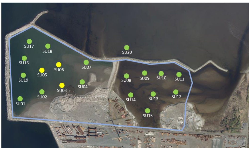
Figur 11: Prøvestasjonene er markert med farge etter høyeste tilstandsklasse av forbindelser funnet i sedimentene.
