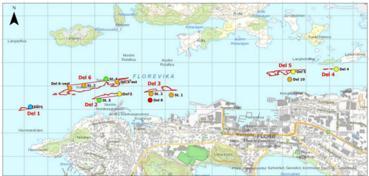
Figur 5 Oversikt sedimentprøver tatt ved/i utdypingsområder i 2012 (Multiconsult) og Rambøll (2020). Høyeste tilstandsklasse (tkl) er markert. Fargekode på punkter; blå= tkl I, grønn= tkl II, gul= tkl III, orange= tkl IV og rød= tkl V (Norconsult, 2021)
