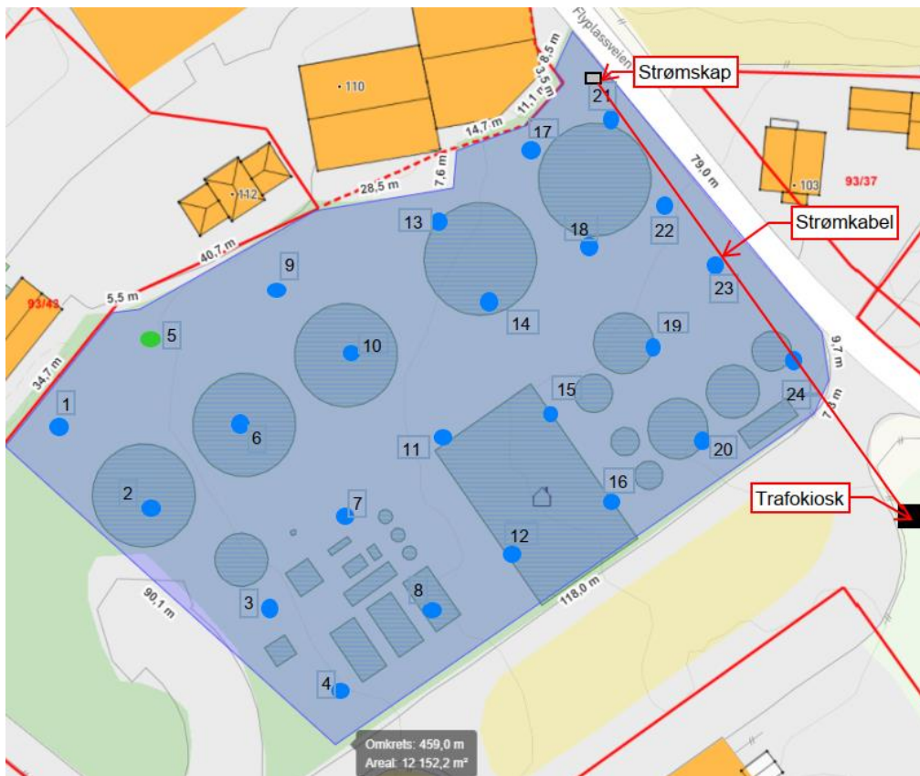
Figur 10: Høyeste påviste tilstandsklasse i undersøkt prøvetakingsdyp. Prøvepunktene er fargekodet iht. tilstandsklassene i veileder TA-2553/2009 (5). ©Kartverket
