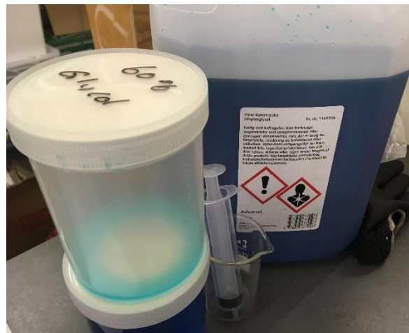
Figur 2 - Konsentrert glykol tynnes ut med vann til 60%
