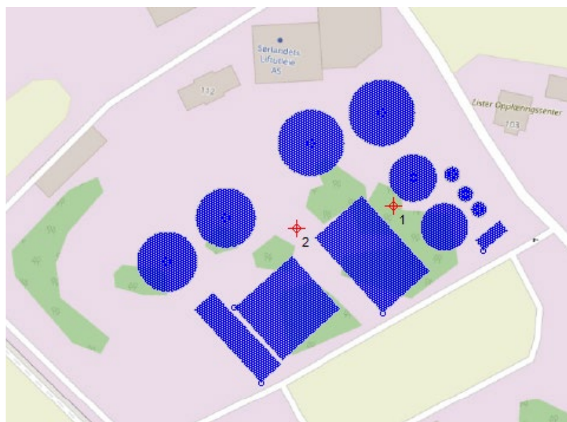
Figur 1: Skisse av anlegget Lista Biogass, inkludert plassering av avkastet, merket i rødt
