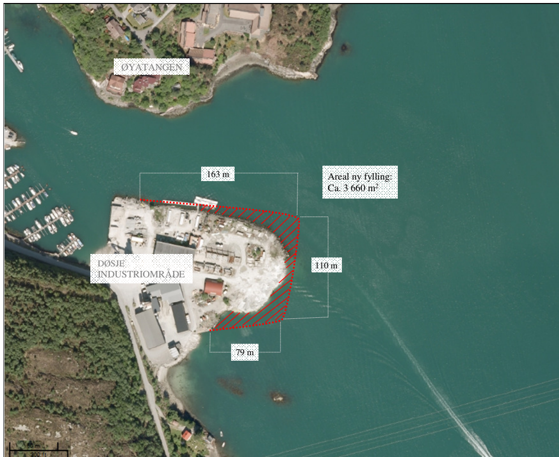
Figur 1. Utfyllingsareal for Døsje industriområde i Fjell kommune, figur utarbeidd frå http://kart.kystverket.no og planteikningar av Furnes Bygg.
