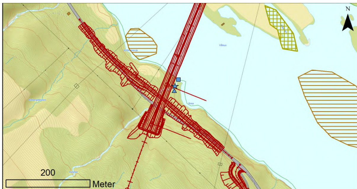
Figur 41. Bekken Kollefall blir sterkt berørt av brukonstruksjonen og nedre del av bekkeløpet må legges om. Stasjoner for vannprøver (firkanter), elektrofiske (stjerner) og bunndyrprøver (trekanter).
