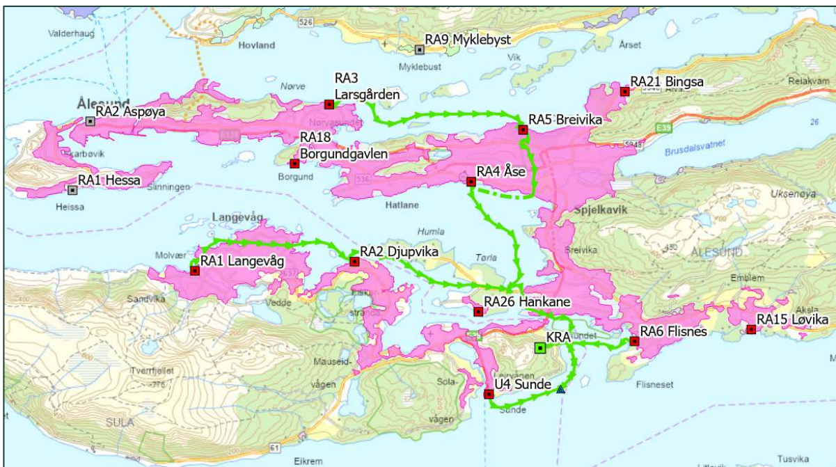
Figur 4-1: Oversikt over Ålesund tettbebyggelse (rosa polygon, Miljødirektoratet 2021), overføringsledninger og renseanlegg i Ålesund og Sula kommuner (røde: overføres til KRA, grønn: KRA og grå: overføres ikke til KRA).
