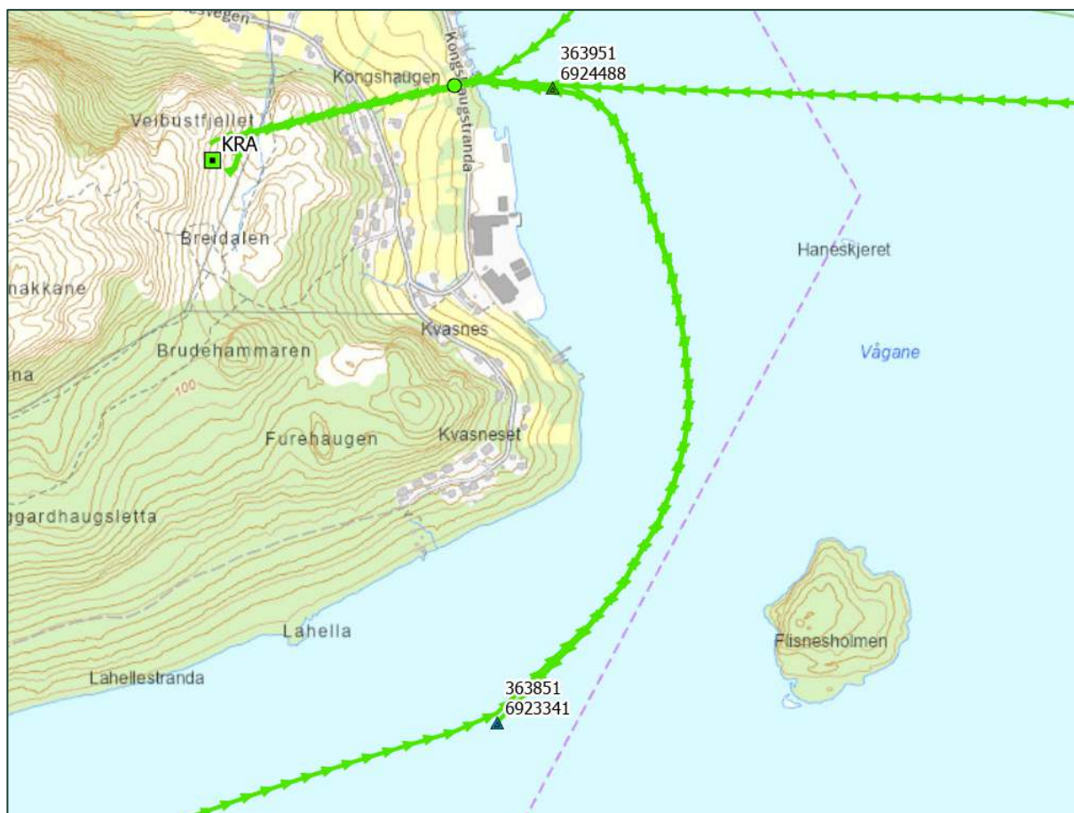
Figur 6-7: Utslippspunkt for rensset avløpsvann (UTS) og nødoverløp (NO) fra renseanlegget (med UTM-koordinater).
