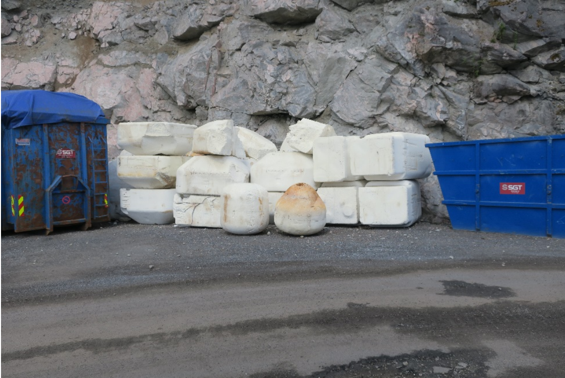
Bilde 3: EPS lagret utendørs uten sikring.
