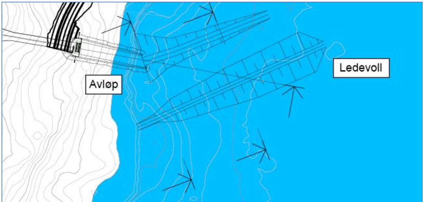
Figur 3-12. Plantegning som viser avløp og ledevoll i Fivlemyrane.
