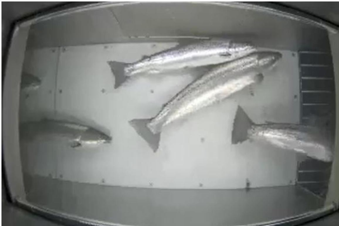
Bilde 2: Fem sjørreter passerer telleren samtidig. I et slikt tilfelle lagrer telleren ett videoklipp, men logger samtidig fem fisk forbi telleren. Det er 20 cm mellom hver sorte prikk i bakkant av kammeret.
