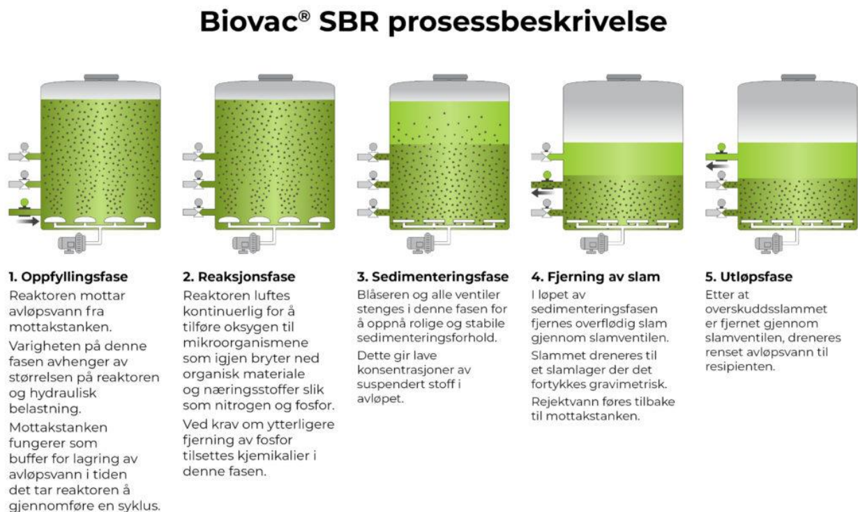
Figur 3 Beskrivelse av SBR renseprosess (hentet fra biovac.no)
