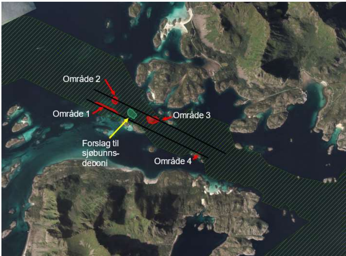
Figur 2 Flyfoto som viser det definerte «Farledsarealet» gjennom Molldøra med grønn skravur. De røde områdene viser planlagte utdypingsområder. Grønn markering viser forslag til sjøbunnsdeponi av massene fra utdypingene. Sorte linjer viser nordre og søndre avgrensning av planlagt led gjennom Molldøra mens grønn skravur viser det definerte «Farledsarealet» for farled. Del 4 er tatt ut av prosjektet.
