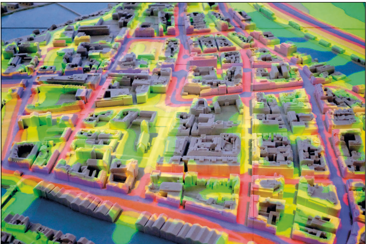
Figur 7.14 Støysoner projisert på ein bymodell av Trondheim. Tredimensjonale modellar gjer det enkelt å visualisere kommuneplanen og andre aktuelle tema for innbyggjarane.
