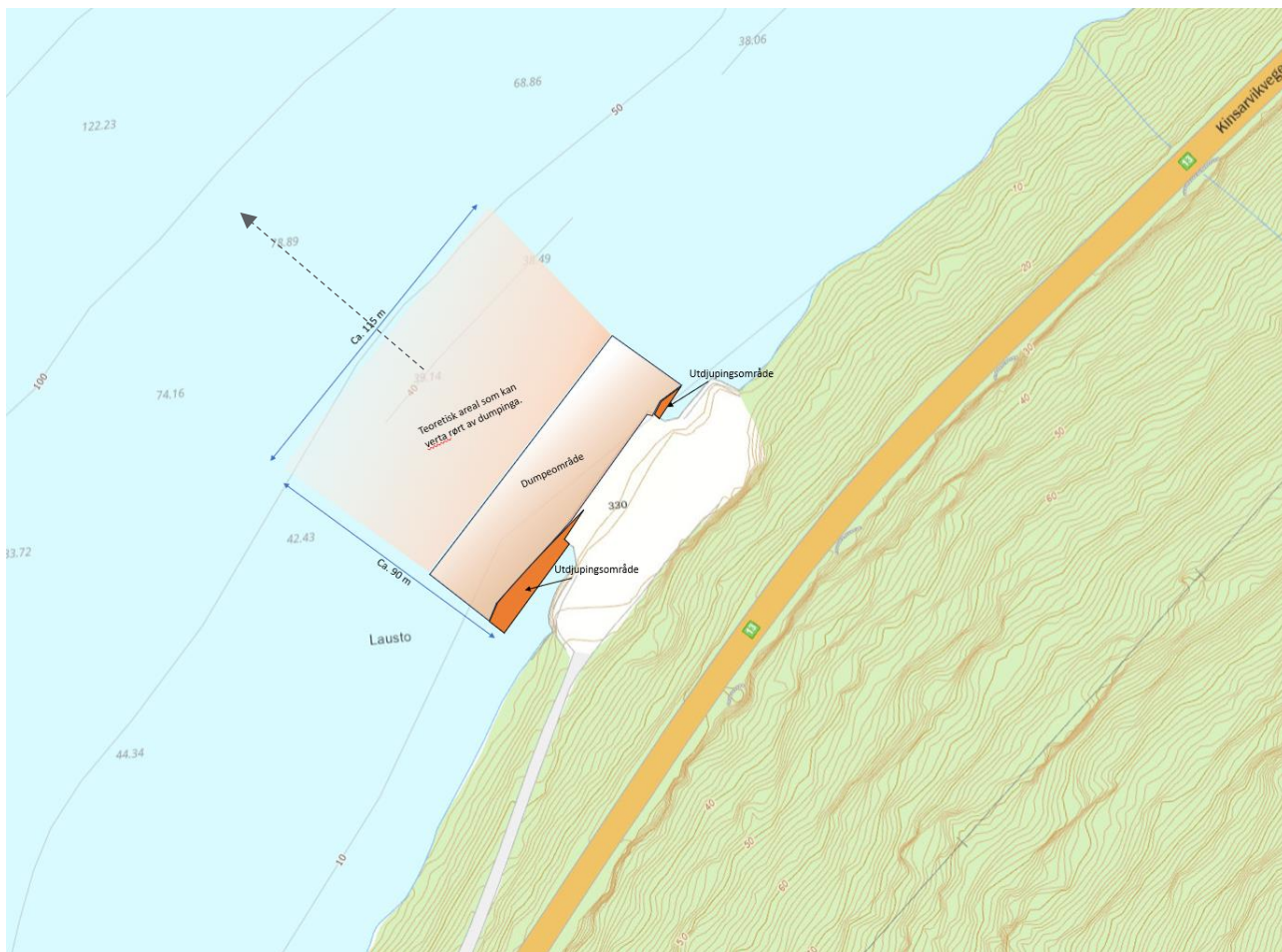
Figur 6: Oransje polygon markerer omtrentleg kvar det skal sprengjast («Utdjupingsområde»). Dumpeområde er angjeve nærast utdjupingsområdet, og teoretisk areal som kan verta rørt av dumpinga er også illustrert. Grå, stipla pil illustrerer uvissa knytt til om dumpa massar også vil legge seg utanfor markert areal på kartet.
