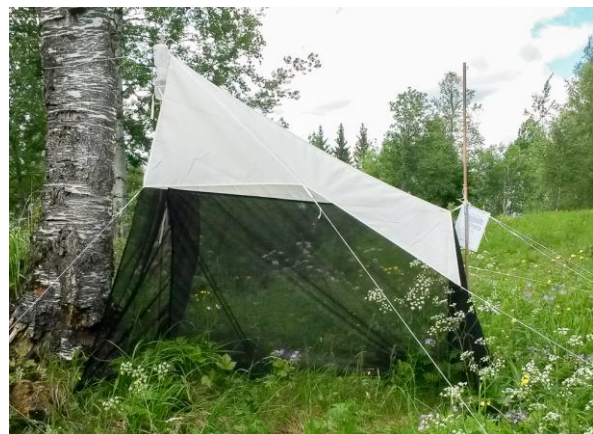
Figur 47. Malaisefelle for innsamling og overvåking av flygende insekter. Foto: Hallvard Elven.
