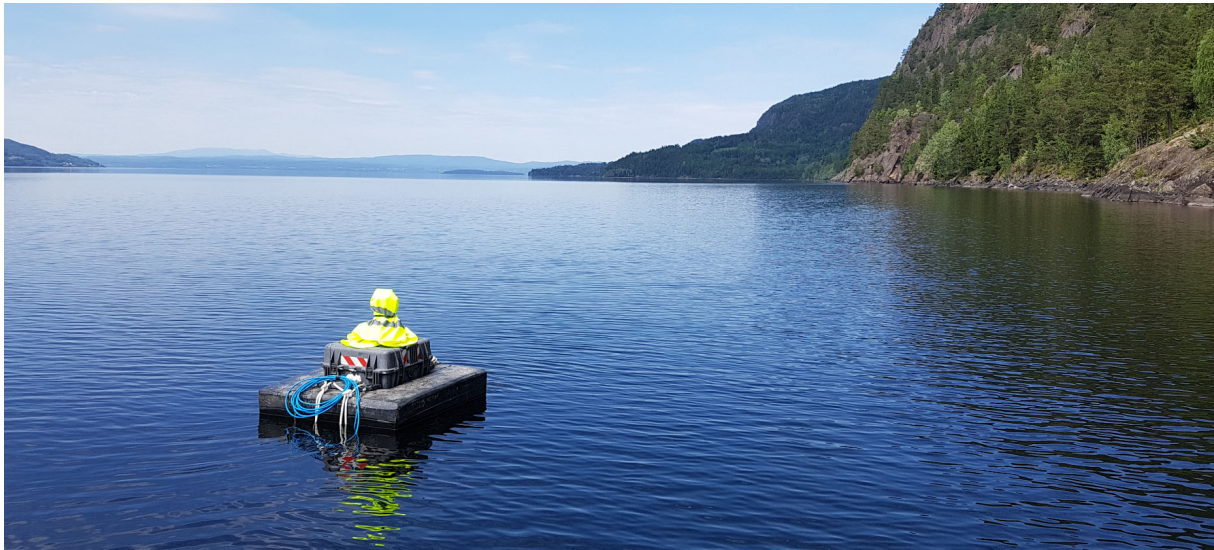
Figur 24. Viser miljøbøye på stasjonen HOL-N utenfor Nordlandsbekken, med sensorer for målinger i tre dyp (Foto: Johanna Skrutvold, NIBIO).
