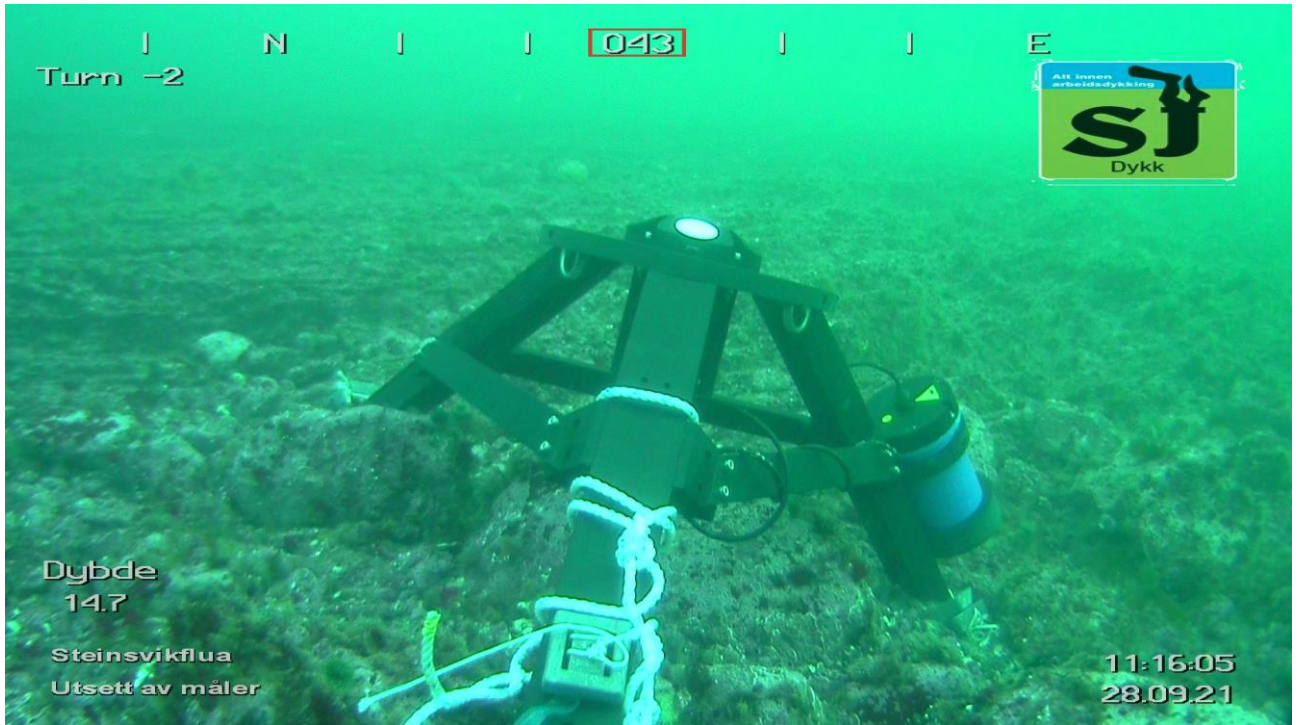
Figur 15: Bilde av strømriggeren ved Steinsvikflua (fra SJ Dykk)
