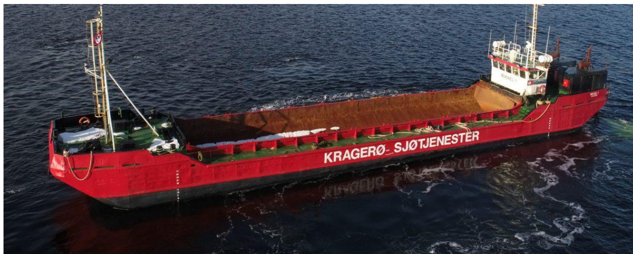
Figur 14: Selvgående splittlekter med en kapasitet på 300 m 3 . Foto: Kragerø Sjøtjenester
