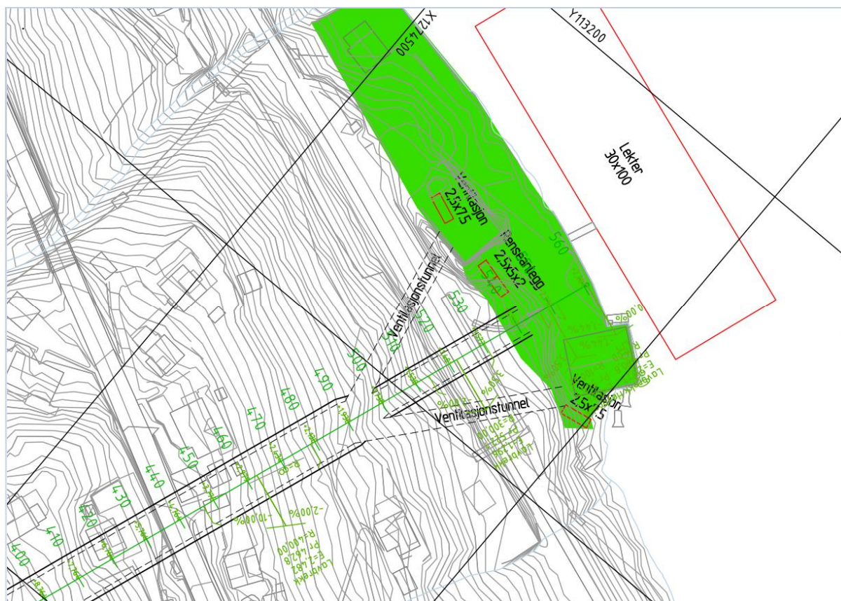
Figur 66: Transporttunnel til Boge kai. Stigning 10%. Kun 8 meter mellom vegoverflate til underbygning jernbane gir anleggstekniske utfordringer til utførelse og dimensjoner på tunnel.
