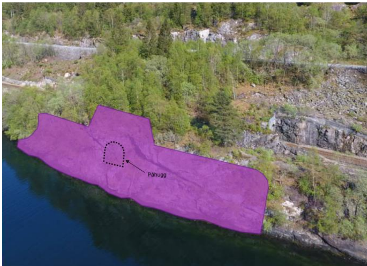
Figur 38: Foto av området for tverrslaget på Linnebakkane, med illustrert påhugg. Portal for eksisterende Lille Fossmark II tunnelen kan skimtes. I forkant av denne ligger forskjæringen inn mot den korte, utrangerte tunnelen. Foto: Øystein Lohne
