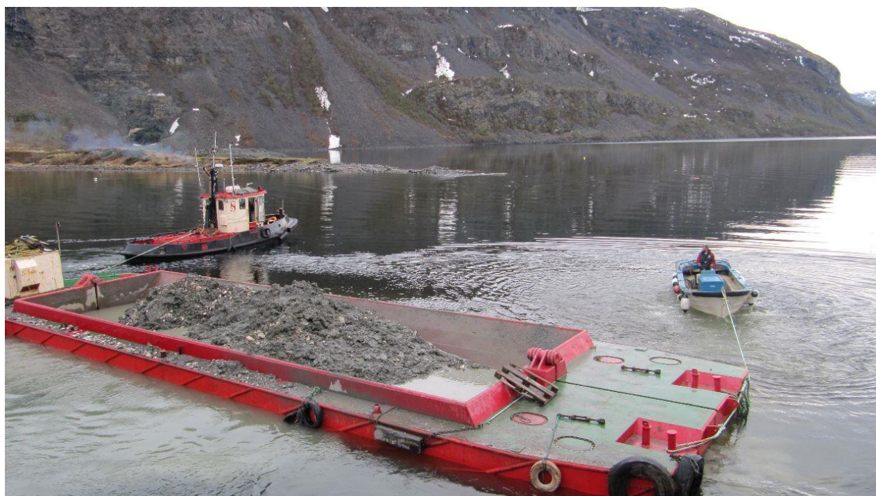
Figur 15: Splittlekter med en kapasitet på 150 m 3 . Foto: Gerd Stensen AS
