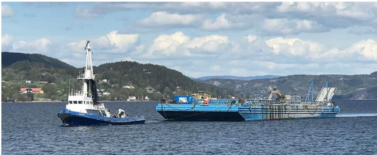
Figur 16: Flatlekter for steintransport 3 000 t, alt. 10 000 t. Foto: Polar Tugs / Hæhre
