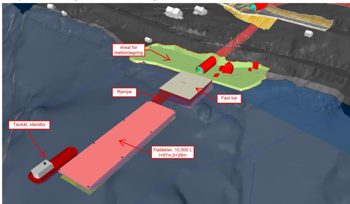
Figur 31: 3D-illustrasjon -Prinsippskisse kaianlegg for flatlekter og splittlekter på Fossmark (MK01).
