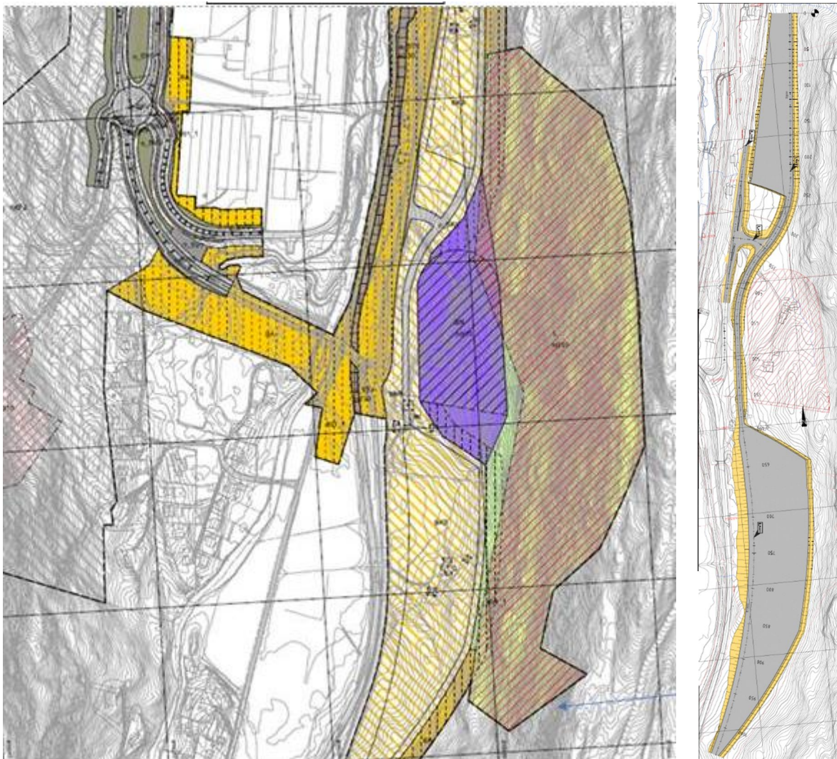
Figur 43: Riggområde ved Espeland nord. Til venstre: Det aktuelle riggområdet er det lysegule arealet. Til høyre: Mer detaljert kart over riggområdet (grått areal)
