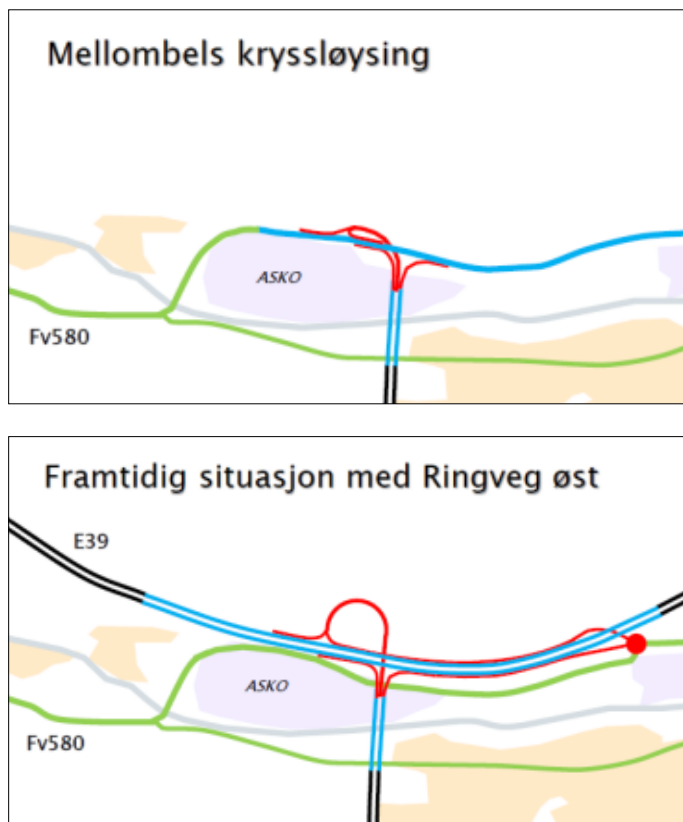
Figur 5-29: Vegsystem i Arnadalen utan og med framtidig Ringveg aust. Kjelde: Statens vegvesen.
