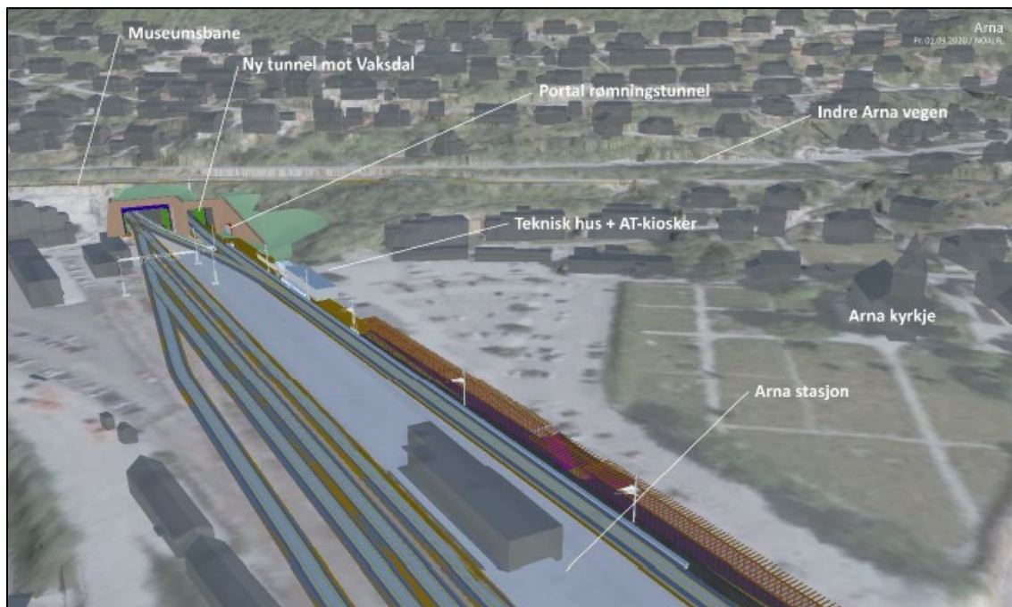
Figur 5-49: Utklipp frå modell som viser Arna stasjon med nye portalar, nytt teknisk bygg og nye spor mot aust.
