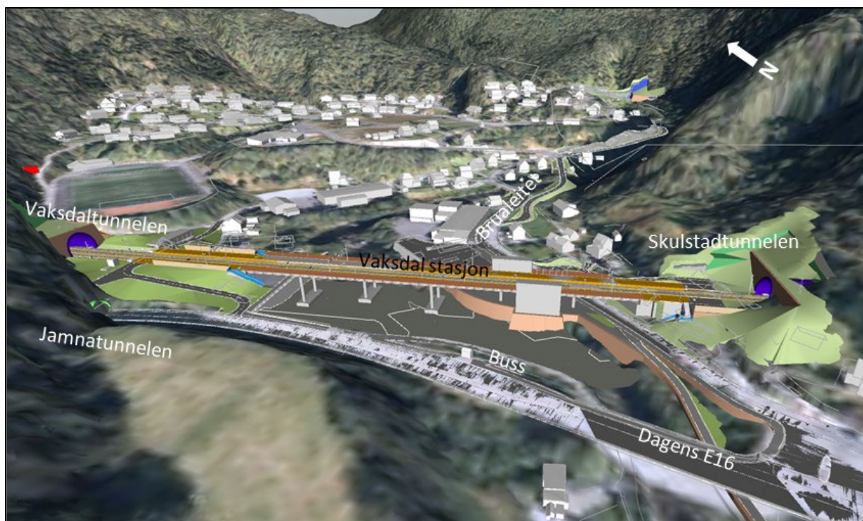
Figur 5-23: Ny situasjon for planforslag B2 på Vaksdal. Ny stasjon på bru over dalen, aust for eksisterande E16.
