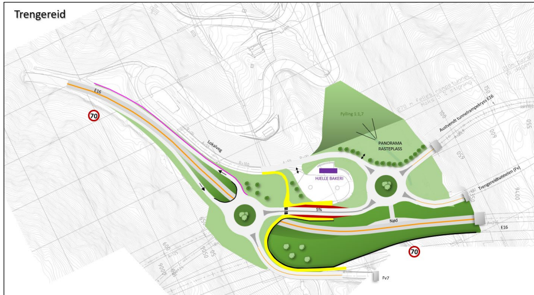
Figur 12-3 Midlertidig kryssløysing med byggetrinn E.
