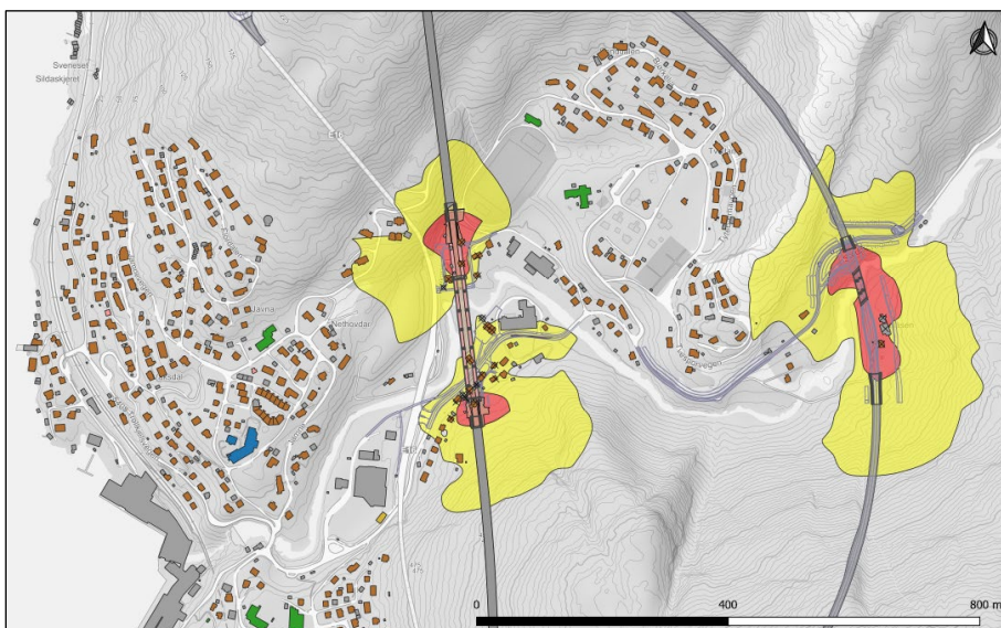
Figur 5-98 Alt.B2 Vaksdal: 14 bustader blir råka av gul eller raud støysone frå ny veg og jernbane. Støysone viser skjerma situasjon.
