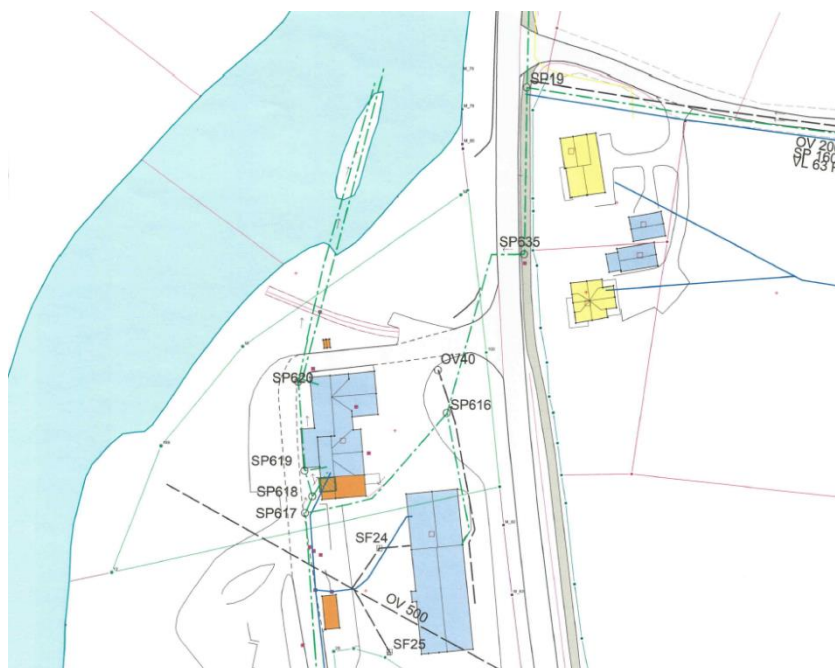
Figur 7: Utslippsledning med utslipp til Stjørdalselva.
